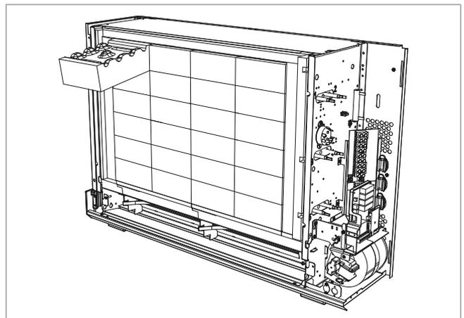
7.11 Oberste Reihe der Speichersteine auf die gleiche Weise einfügen. Prüfen, dass das Heizelement frei gleiten kann. Verklemmte Heizelemente verursachen Geräusche. Luftausblasraum und Schaltraum reinigen.
