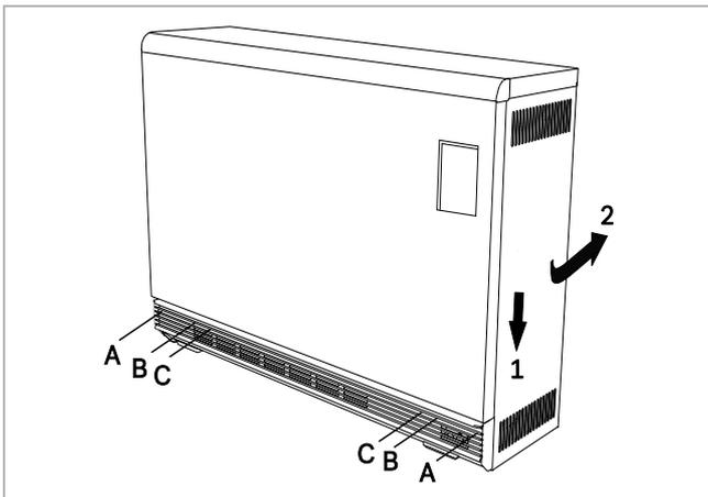
7.3 Schrauben (A) für die Seitenwände entfernen. Seitenwände nach unten schieben (1) und heraus-schwenken (2). Nach Entfernen der Seitenwände die Befestigungsschrauben (B) für die Vorderwand lösen. Schrauben C nicht lösen.
