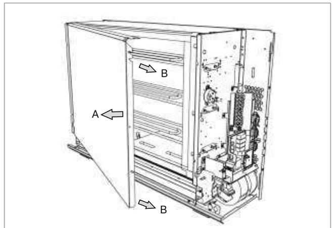
7.6 Kernraumabdeckung entfernen. Dazu die seitlichen drei Befestigungsschrauben lösen. Kernraumabdeckung leicht anheben, nach außen schwenken (A) und anschließend nach rechts ziehen (B).
