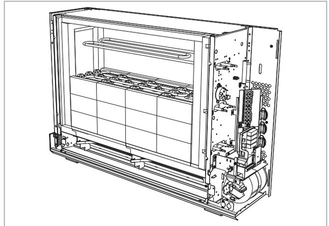
7.9 Nach dem Einsetzen der zweiten Reihe, die dritte Reihe Speichersteine unter dem Heizelement einschieben.
