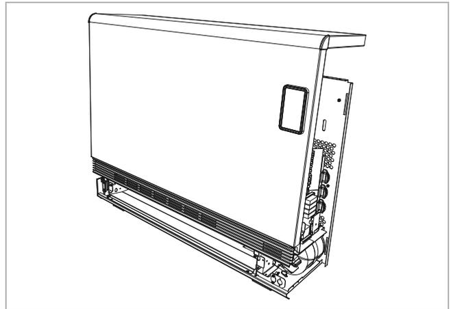
7.5 Vorderwand nach vorne aufschwenken und dabei leicht anheben um es aus seiner hinteren Befestigung zu lösen.
