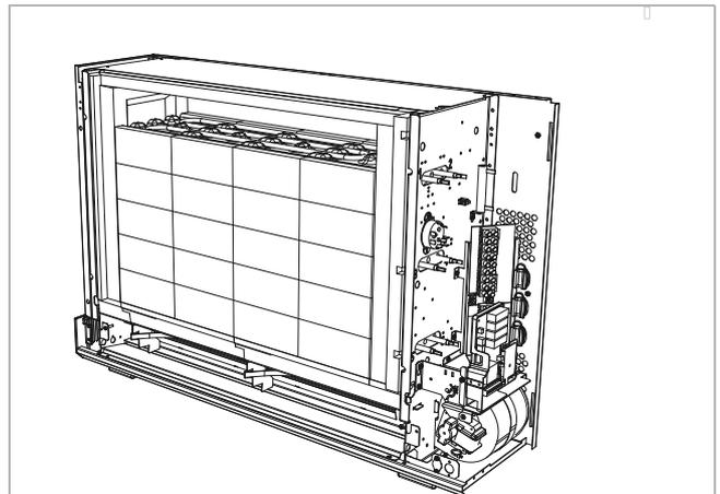
7.10 Nach dem Einsetzen der vierten Reihe, die fünfte Reihe Speichersteine unter dem Heizelement einschieben.
