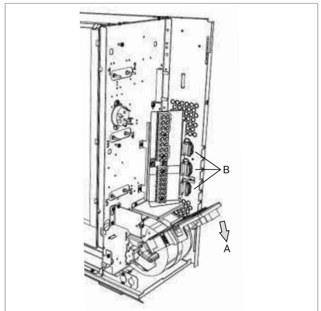
8.1 Hauptelektronik um 90° nach unten klappen (A), um Zugang zu den Anschlussklemmen zu erhalten.
