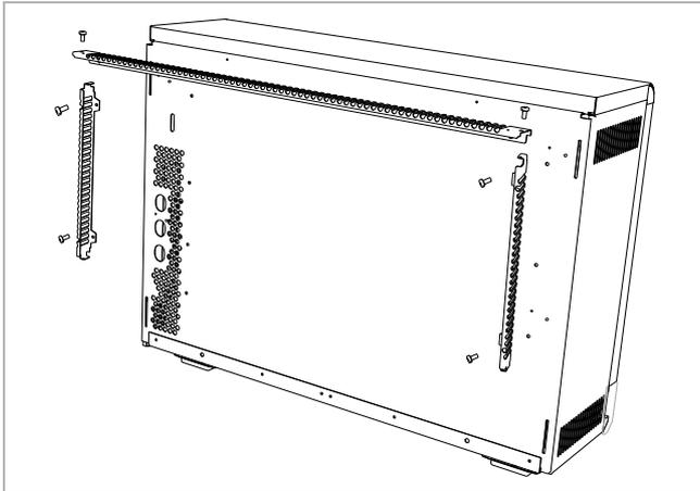
7.2 Die beiden seitlichen Wandanschlussleisten an der Rückseite des Gerätes befestigen. Obere Wandanschlussleiste an den beiden seitlichen Wandanschlussleisten festschrauben.
